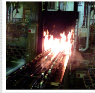
焼き戻しと同時に黒化処理も行います。 (黒染処理)
